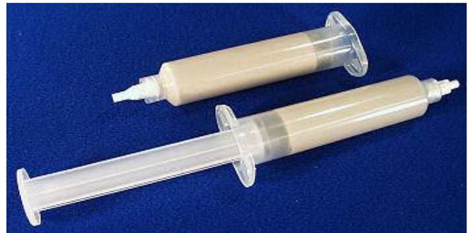
E-Bond SSC-RTV wird direkt aus dem Behälter auf die Klebefläche aufgetragen und mit einer Spachtel verstrichen. Dann werden die Teile unter Druck so zusammen gefügt, dass überflüssiger Kleber ausfließen kann. Am Besten wird der Druck bis zur Aushärtung beibehalten.
